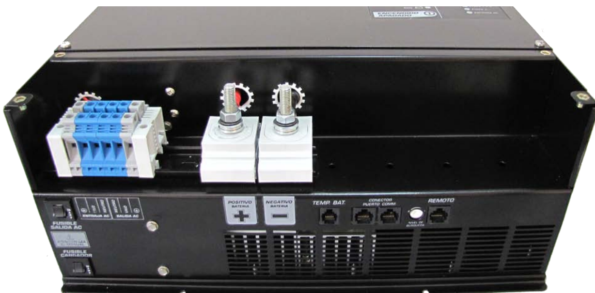
Figura 1-2. Vista de los bornes de conexión
